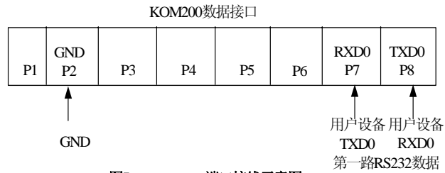
图5 KOM200A端口接线示意图
